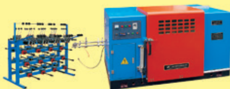
JSF400/500型大平方弓形束线机 JSF400/500 big square arch wire bunching machine
